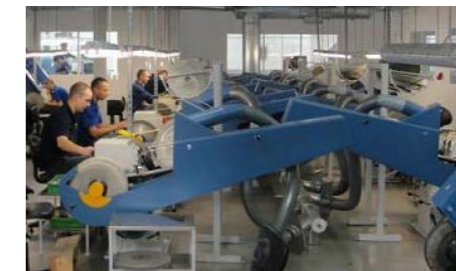
Sondermaschine für Schleifen am freien Band und Drehrichtungsumkehr Special version for slack belt grinding and reverse turning direction
